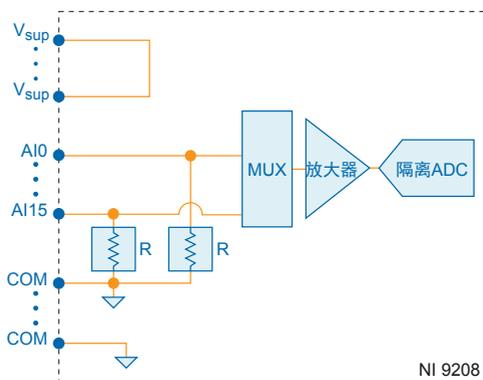
输入信号经扫描、放大和调理后，由单个 24 位 ADC 对其采样。模块为每个通道均提供过压保护。每次只有一个通道可处于过压状态。
